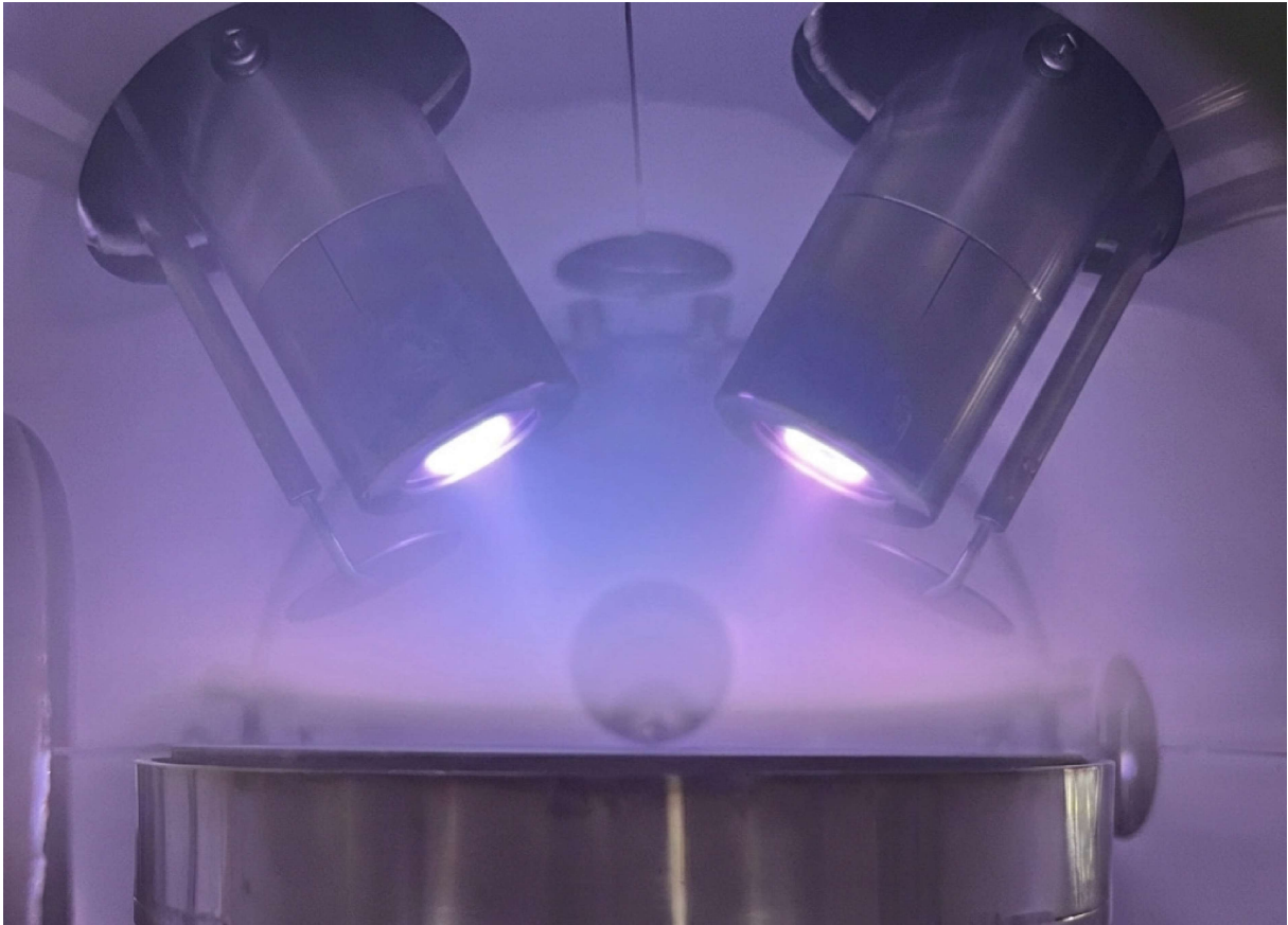
ダイヤモンドライクカーボン薄膜の成膜に用いるプラズマ
